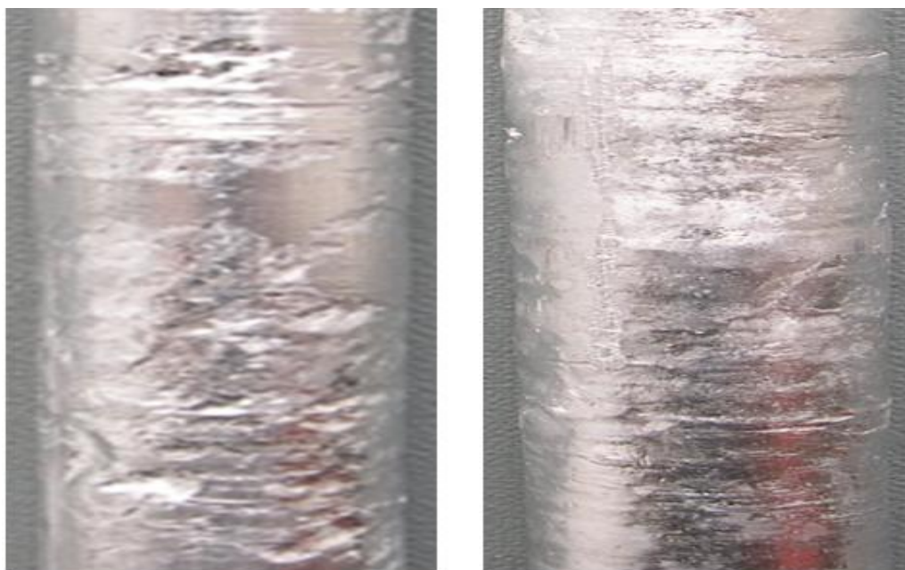
Рис. 4.12. – Якість поверхонь контрольної (а) та віброваної (б) безперервнолитих заготовок з алюмінієвого сплаву АД31
