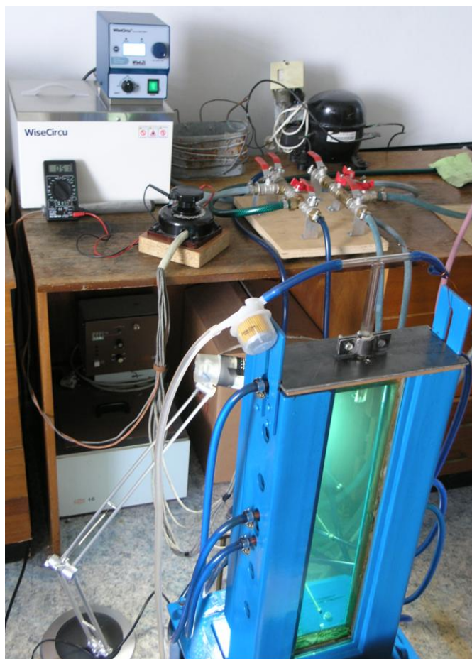
Рис. 2.7. – Експериментальна установка для фізичного моделювання процесів формування литих заготовок
